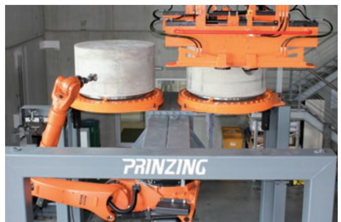
*Les monolithes, qui reposent encore sur la rondelle de base en acier, sont déposés à l'état partiellement durci sur la station de fraisage où ils sont centrés avec précision*
