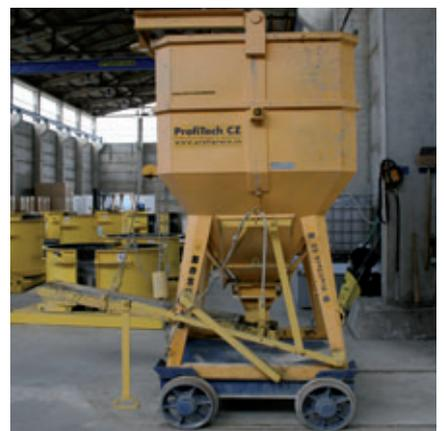
Chez Zábajník s.r.o., le béton est transporté de l'extérieur vers le hall de production au moyen d'un wagon à benne.
