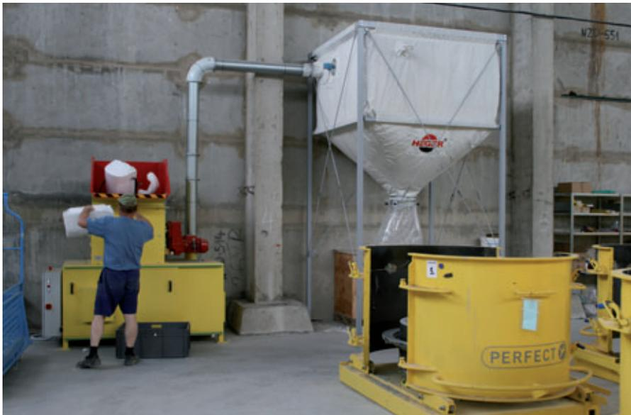
Les éléments en EPS enlevés sont placés et détruits dans un broyeur (Heger GmbH).
