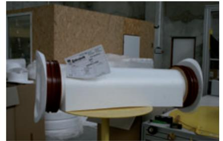
Les éléments en EPS sont découpés au moyen de différentes scies à fil chaud et ensuite assemblés entre eux par collage à chaud.
