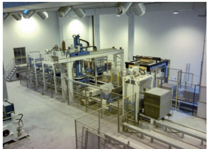
Übersicht der Trockenseite mit Steinlöser, Steindoppler, Paketierung, Brettbürste, Brettwender, Brettstapelgerät und Brettstapeltransportbahn im Vordergrund, im Hintergrund Transportpalettenstilo und Folienwickelmaschine
