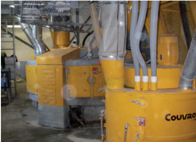
Der Couvrot HTV 420 und der Skako Apollo 3000 sorgen für die richtige „Mischung“
