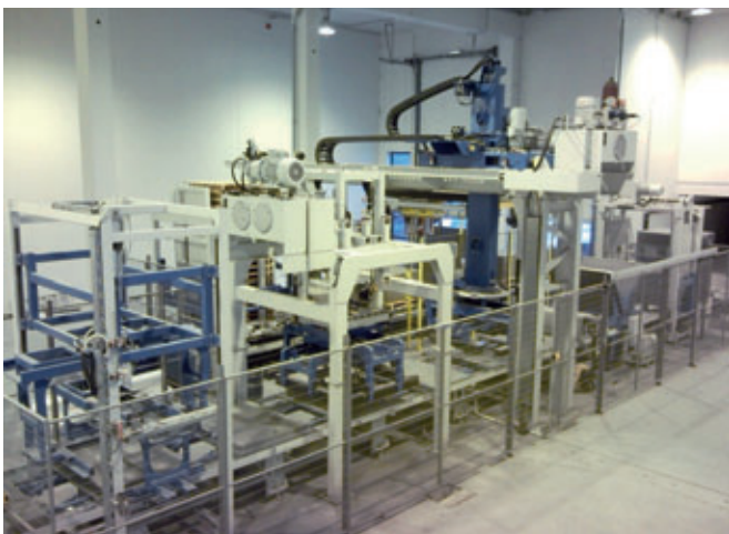
Übersicht der Trockenseite mit Steinlöser, Steindoppler, Paketierung, Brettbürste, Brettwender, Brettstapelgerät und Brettstapeltransportbahn im Vordergrund, im Hintergrund Transportpalettenstilo und Folienwickelmaschine
