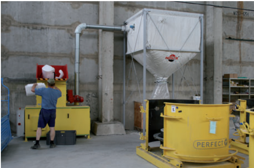
Die entfernten EPS-Körper werden in einen Schredder (Heger GmbH) gegeben und zerkleinert
