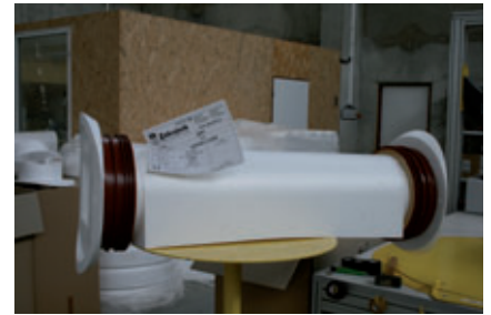
Die EPS-Körper werden mittels unterschiedlichen Heißdraht-Sägen zugeschnitten und dann mit Heißkleber miteinander verklebt
