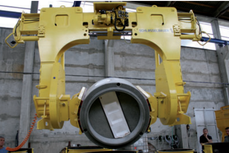
Mit dem speziellen Wendegreifer werden die Schachtunterteile aufgenommen und um 180° gedreht
