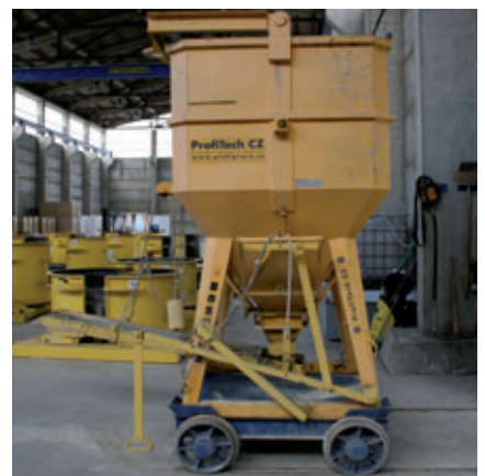
Der Beton wird bei Zábajník s.r.o. mittels eines Kübelwagens vom Außenbereich in die Produktionshalle gefahren
