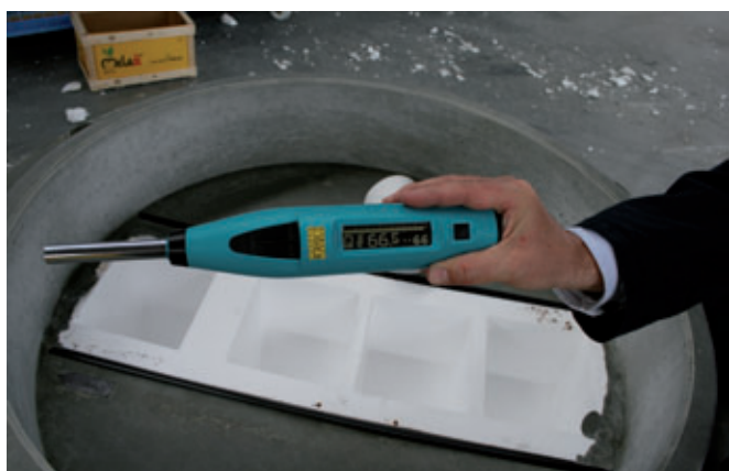
Festigkeitsprüfung mit dem SilverSchmidt von Proceq
