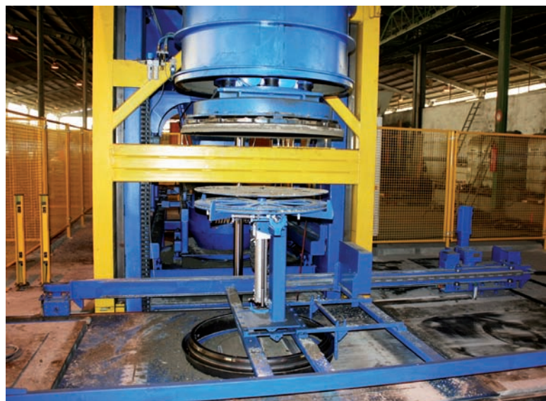
Автоматическая закладка грузоподъемных петель
