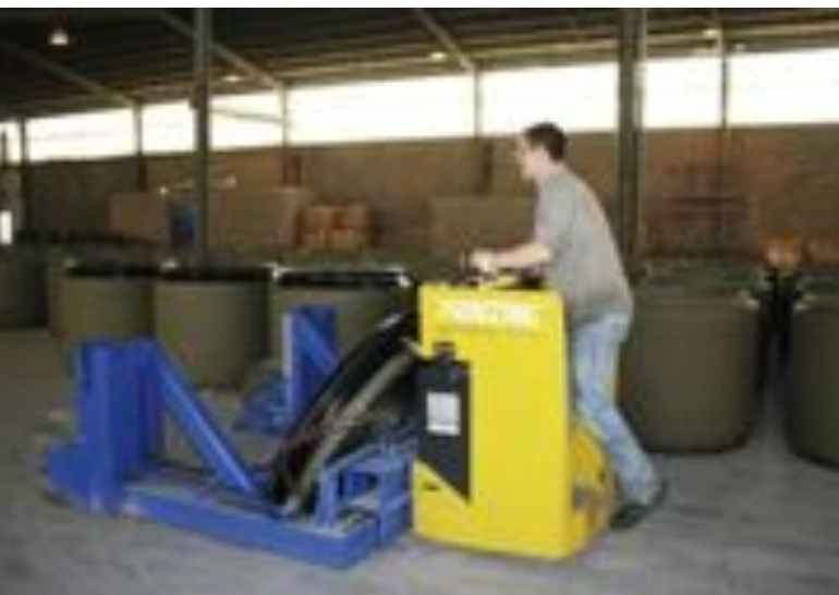
Elektryczny wózek transportowy.
