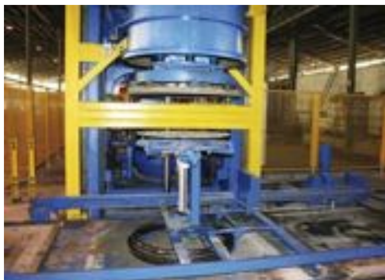
Automatyczne wkładanie kotew transportowych.
