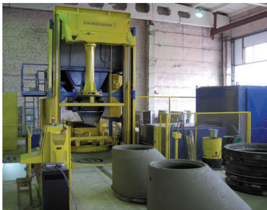
Produzione di coni per pozzetti presso la OOO «SMK-50» con il nuovo impianto di produzione Magic della Schlüsselbauer
