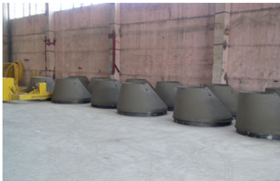
Coni nell'area del capannone produttivo della OOO <<SMK-50>> riservata all'indurimento
