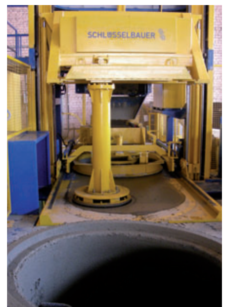
Ciclo di produzione: viene infilato il fondello, lo stampo viene riempito con il calcestruzzo, dopo la compattazione il cono per pozzetto viene liberato dallo stampo e rimosso dall'impianto
