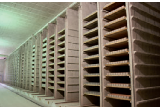
Les rayonnages comptent 31 chambres d'une capacité de 10.200 planches
