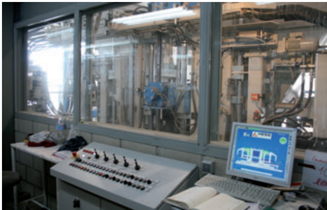
Le mélangeur et la production de blocs sont surveillés à partir de la salle de commande centrale
