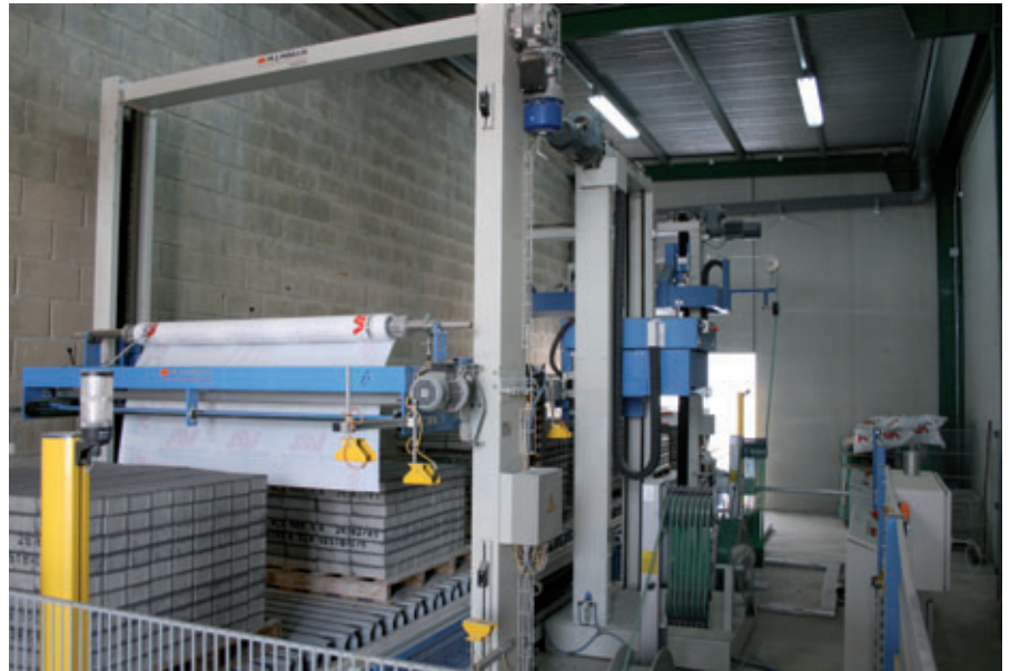
Une banderoleuse et une cerceuse horizontale et verticale assurent ensuite la protection des produits pour leur stockage et leur transport
