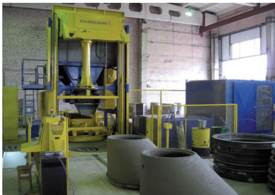
Produktion von Schachtkonen bei OOO <<SMK-50>> mit der neuen Produktionsanlage Magic von Schlüsselbauer
