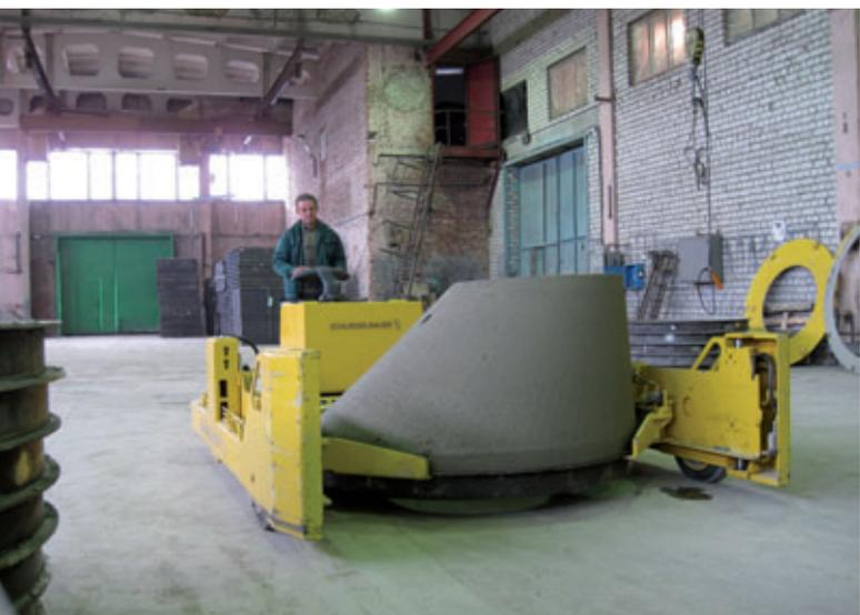
*Der Transport der Produkte erfolgt mittels elektrischem Abfahrwagen*
