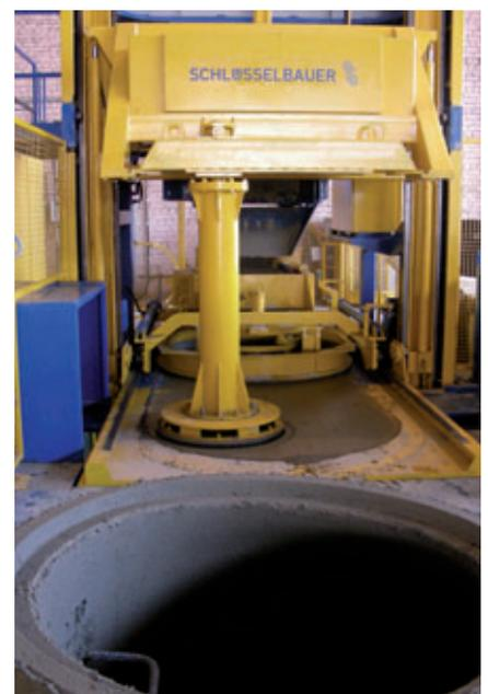
Produktionsablauf: Muffe wird eingeschoben, Form wird befüllt und der Kone nach Verdichtung entschalt und aus der Anlage geschoben
