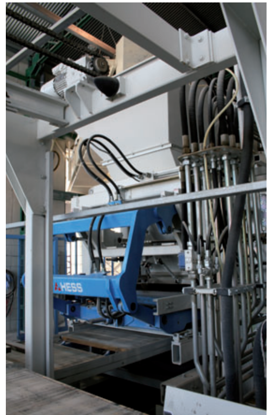
Auf der Betonsteinfertigungsmaschine RH 1500-2 VA können alle gängigen Betonprodukte bis zu einer Höhe von 400 mm gefertigt werden
