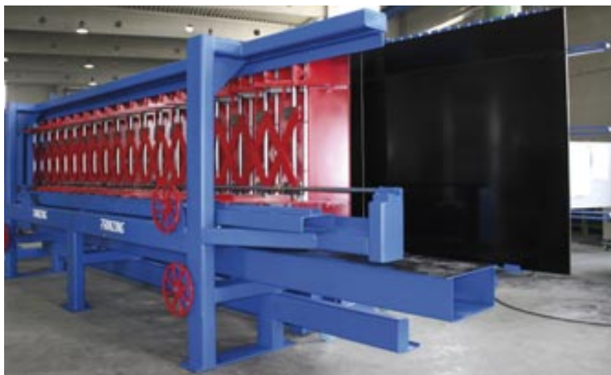
Regulowany szalunek schodowy do produkcji prefabrykowanych prostych schodów betonowych
