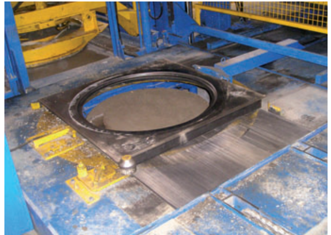
Ciclo di produzione: viene infilato il fondello, la forma viene riempita con il calcestruzzo, dopo la compattazione il cono per pozzetto viene liberato dalla forma e rimosso dall'impianto.
