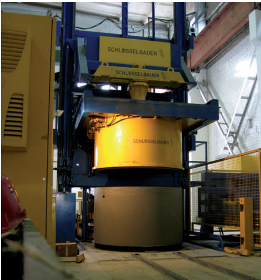
La ditta Kauno Gelzbetonis ha acquistato un nuovo impianto della Schlüsselbauer per la produzione di anelli e coni per pozzetti.
