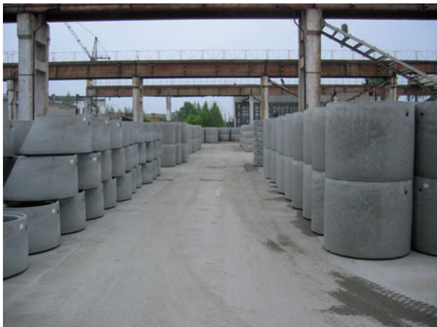
Attuali strutture per pozzetti per l'impiego nella costruzione del sottosuolo in Lituania. Nella figura coni e anelli per pozzetti presso la ditta Kauno Gelzbetonis.
