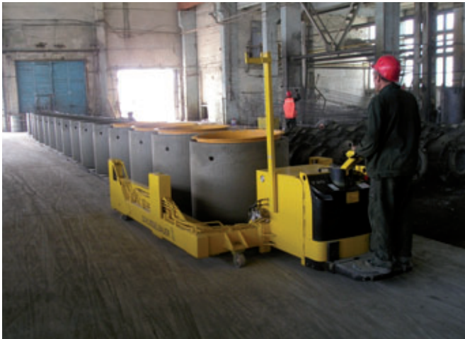
La Magic 1501 presso la ditta Kauno Gelzbetonisè disegnata per due manovali
