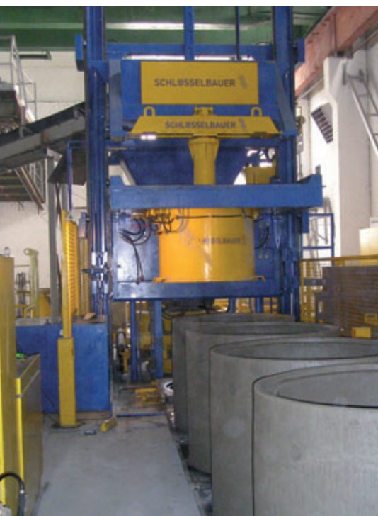
Prodotti umidi nella "zona parcheggio" e prima del trasporto nella zona di essiccazione.
