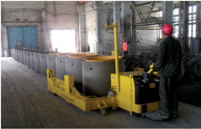
La machine Magic 1501 installée chez Kauno Gelzbetonis est conçue pour être commandée par deux opérateurs
