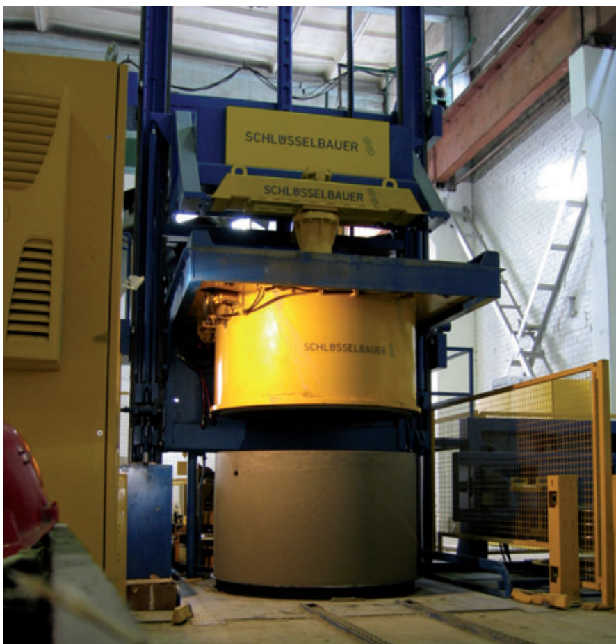
Für die Produktion von Schachtringen und -konen hat die Firma Kauno Gelzbetonis die neue Schlüsselbauer-Produktionsanlage angeschafft
