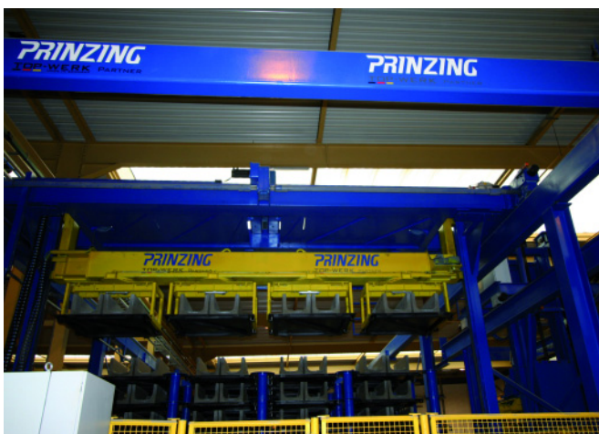
Благодаря интеллектуальной концепции кран-робота и стеллажей выдержки, все производство занимает минимум площади
