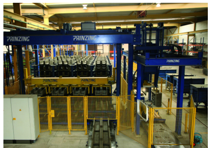
Благодаря интеллектуальной концепции кран-робота и стеллажей выдержки, все производство занимает минимум площади
