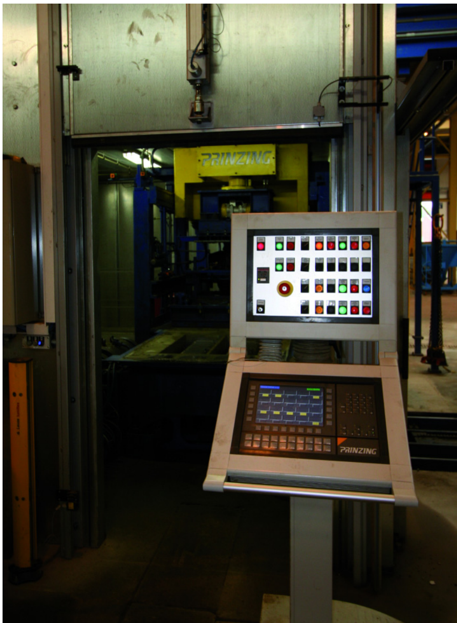
С помощью мониторов пульта управления оборудования Blizzard осуществляется контроль за всеми производственными параметрами
