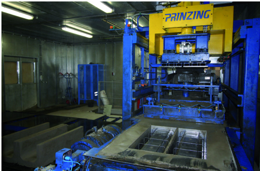
Незначительный уровень шума, благодаря звукопроницаемому исполнению установки Blizzard
