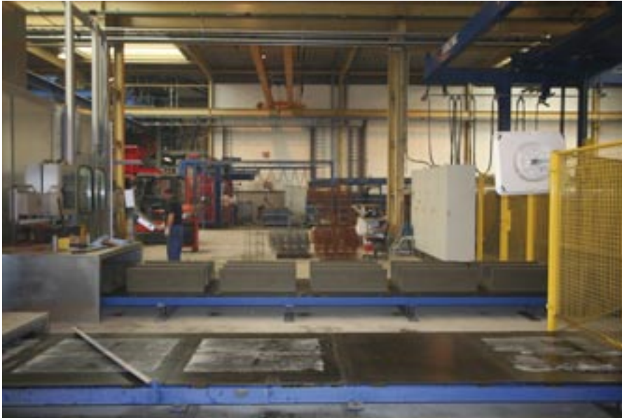
W tle widoczne są świeże wyroby betonowe transportowane z obszaru produkcji do magazynu, na pierwszym planie opróżnione blaty są przez stanowisko automatycznego czyszczenia z powrotem doprowadzane do obiegu produkcyjnego.
