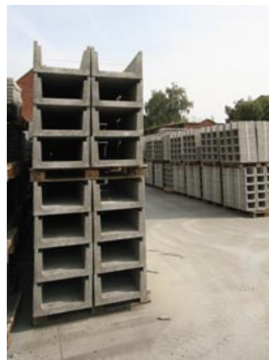
Kanały kablowe dla belgijskiej kolei.
