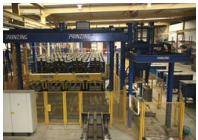
Dzięki wymyślnej koncepcji robota suwnicowego i regatów cała linia charakteryzuje się małym zapotrzebowaniem powierzchni.
