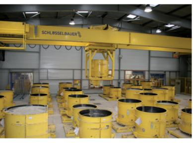
Gli stampi di acciaio vengono depositati e spostati tramite gru robotizzata nell'area di indurimento.
