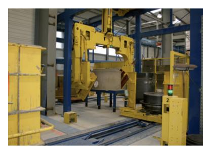
Il prelievo dell'elemento di fondo del pozzetto indurito e il successivo rovesciamento avvengono in maniera completamente automatizzata.
