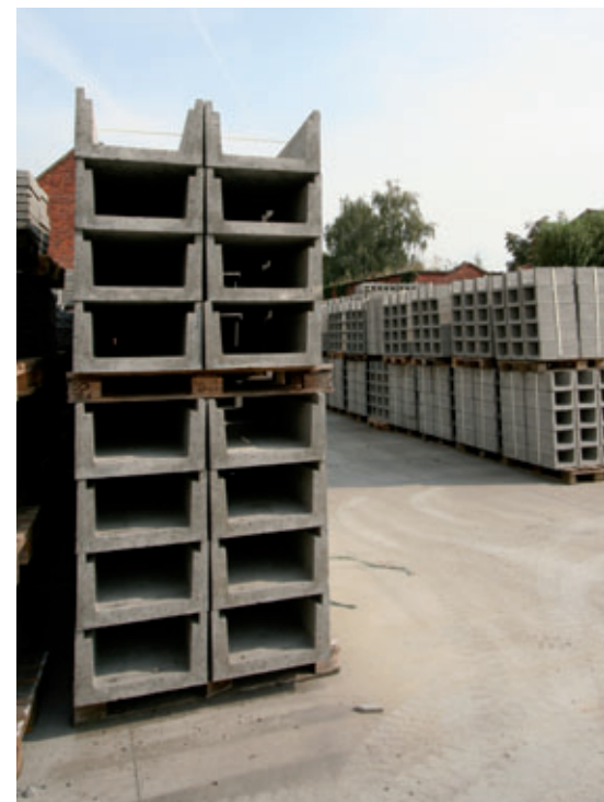
Cunicoli per cavi per le ferrovie del Belgio
