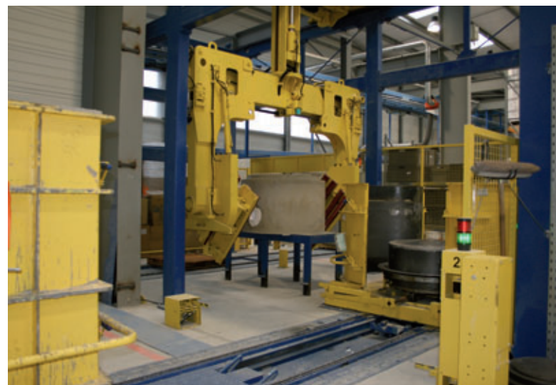
Le démoulage du fond de regard durci et ensuite son retournement sont effectués entièrement en automatique.
