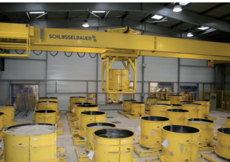
Sur la zone de maturation, l'entrée et la sortie des moules métalliques sont gérées par le pont roulant automatisé.
