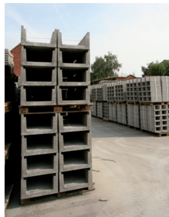
Caniveaux à câbles pour les chemins de fer belges
