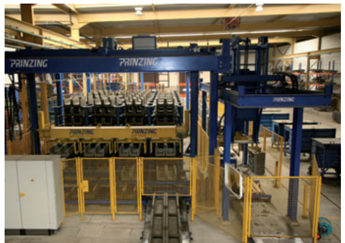
Grâce au concept étudié du portique-robot et du système de rayonnages, l'ensemble de l'installation ne requiert que peu de place
