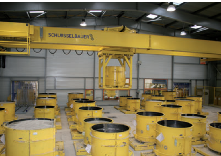
Die Stahlformen werden mittels Roboterkrane im Aushärtebereich ein- und ausgelagert
