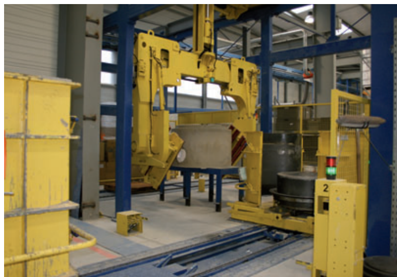
Das Entnehmen des ausgehärteten Schachtunterteils und das anschließende Wenden erfolgen vollautomatisch
