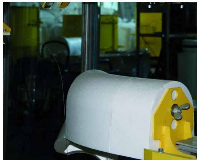
"Трехмерный" разрез пенополистирольной детали.
