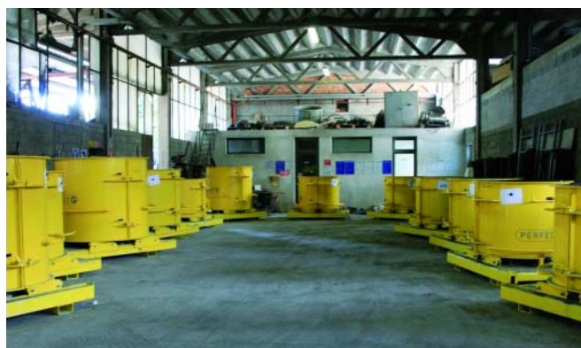
Производственный цех фирмы Buzzella Ennio S.r.l.: формы Perfect для колец с днищем внутренним диаметром 1000 мм и 1200 мм.
