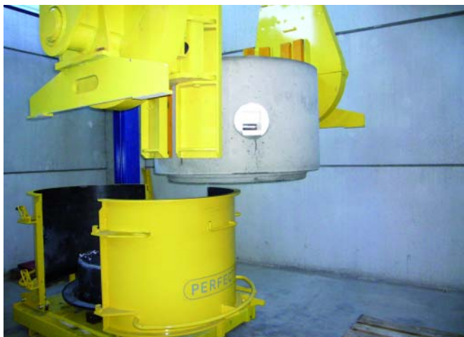
Извлечение из формы набравшего прочность монолитного кольца с днищем.
