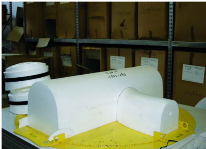
Склеивание вставки-вкладыша – на рисунке диаметр ввода 200 мм, диаметр водовода 300 мм.
