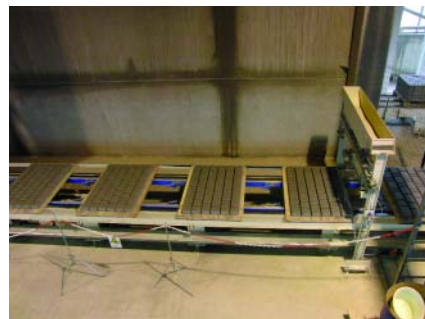
Рис.4b+c. Компоновщик пакетов размещает слои изделий на транспортировочной паллете
