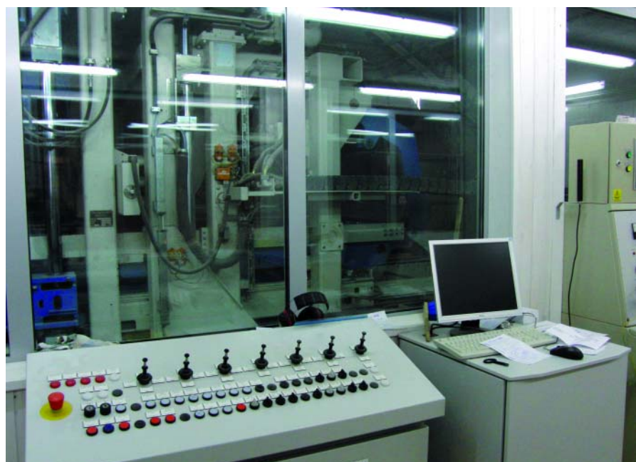
Рис.2. Сердце установки Hess RH 1500-2 VA с размером стола 1400 x 950 мм
