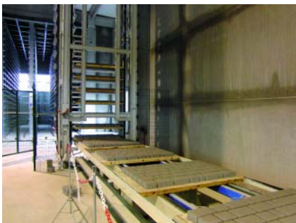
Рис.4b+c. Компоновщик пакетов размещает слои изделий на транспортировочной паллете
