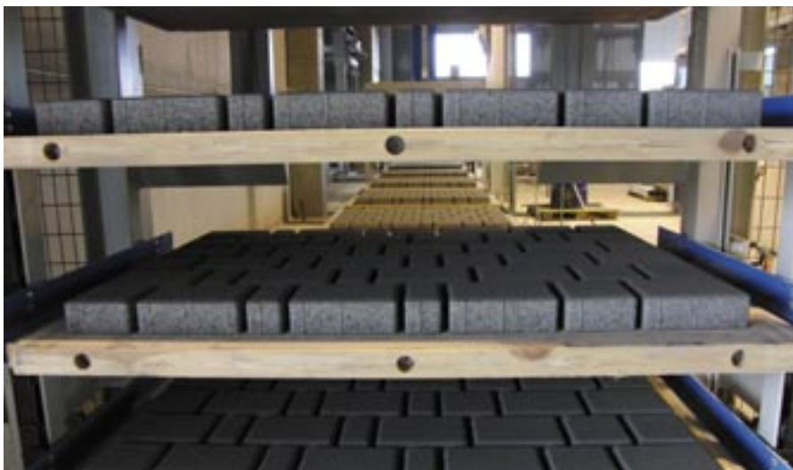
4a: Stwardniałe produkty są wyjmowane ponownie za pomocą wózka wielowidłowego i przenoszone do windy rozpiętrującej.
