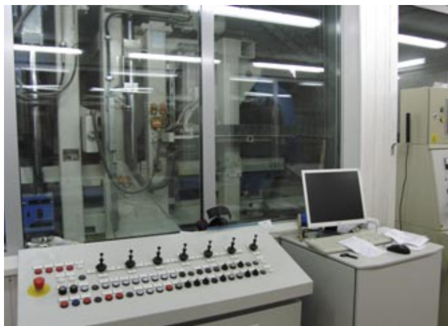
2: Sercem linii jest wibroprasa RH 1500-2 VA firmy Hess, przystosowana do blatów w formacie 1400 x 950 mm.
