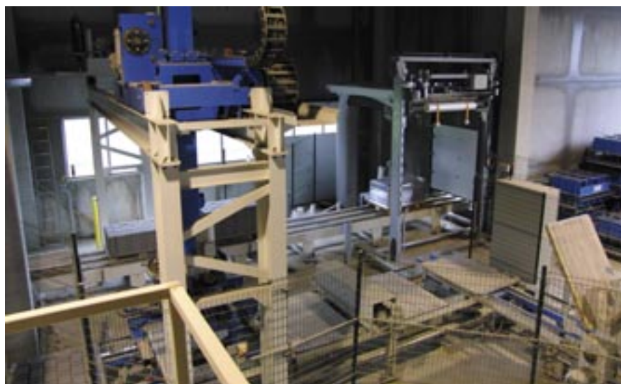
5: Urządzenie pakietujące przekłada warstwy produktów na paletę handlową. Gotowa paczka kostki brukowej jest transportowana przenośnikiem do automatu owijającego folią, a następnie wyjeżdża na zewnątrz hali produkcyjnej.
