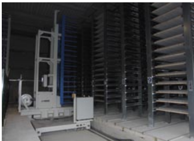
3: Wózek wielowidłowy umieszcza blaty produkcyjne w regale dojrzewania firmy Rotho, ustawionym naprzeciwko linii.
