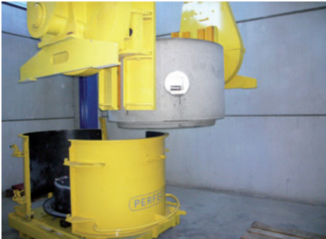
Estrazione dell'elemento di fondo indurito dallo stampo
