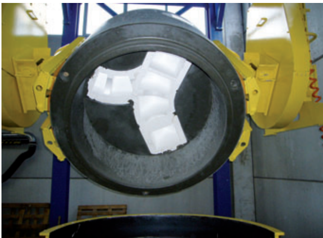
Canali di scolo ideali sotto il profilo idraulico, impiego di guarnizioni integrate per collegamento semplice e sicuro alle tubature
