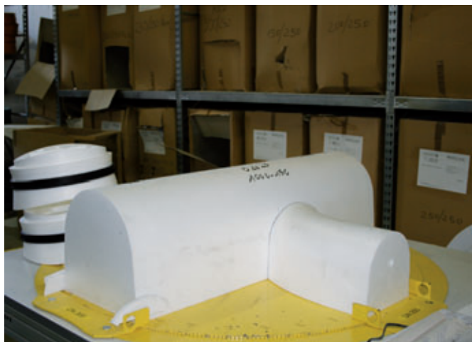
Montaggio di una cassaforma negativa – Nella figura imboccatura DN200 in un canale di scolo principale DN300
