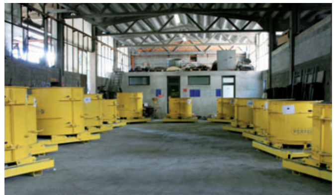
Sede di produzione della ditta Buzzella Ennio s.r.l.: stampi per colata Perfect per gli elementi di fondo per pozzetti DN1000 e DN1200
