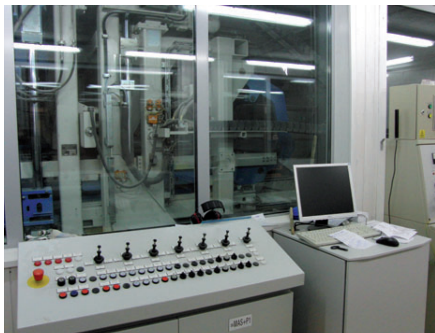
Fig. 2: Il cuore dell'impianto è una Hess RH 1500-2 VA con tavole 1400 x 950 mm
