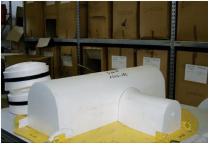
Assemblage d'une cunette en négatif – L'illustration présente une entrée de diamètre nominal 200 raccordée à un canal principal de 300
