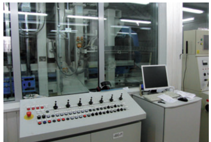
Fig. 2: Le cœur de l'installation est une machine Hess RH 1500-2 VA avec planches de support aux dimensions de 1400 x 950 mm
