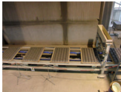
Fig. 4b/c: Après leur séparation, les produits sont transportés jusqu'à l'empaqueteur par le biais d'un convoyeur à cliquets
