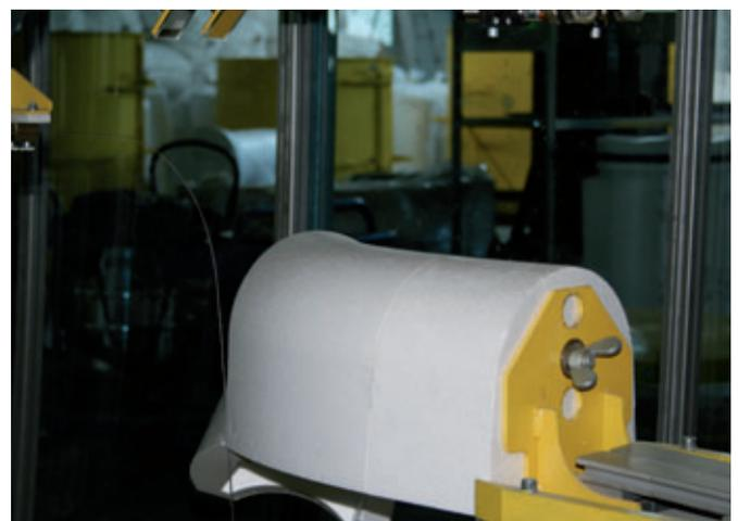
Der „dreidimensionale“ Schnitt eines EPS-Formteiles
