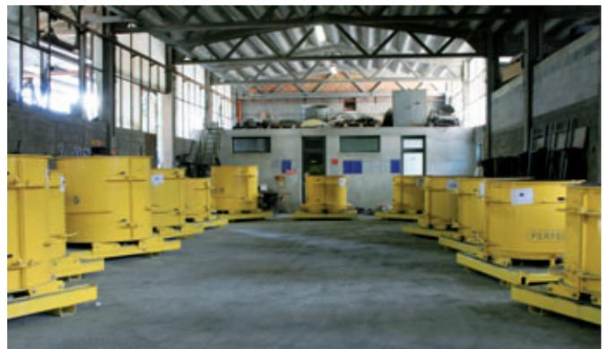
Einblick in die Fertigungshalle von Buzzella Ennio SRL: Perfect-Gießformen für Schachtunterteile DN1000 und DN1200
