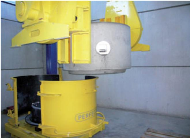
Entnehmen des schalungserhärteten monolithischen Schachtunterteils aus der Gießform
