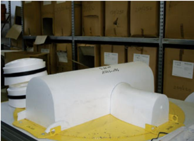
Zusammenbau eines Negativ-Formkörpers – im Bild Zulauf DN200 in ein Hauptgerinne DN300
