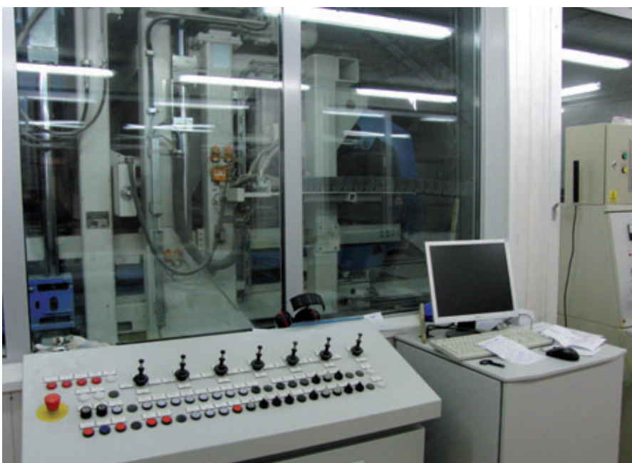
Abb. 2: Herzstück der Anlage ist eine Hess RH 1500-2 VA mit einer Brettgröße 1.400 x 950 mm.
