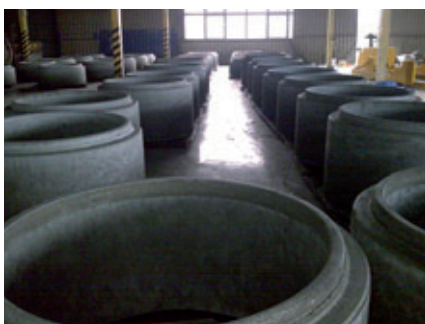
Coni e anelli per pozzetti nell'area di asciugatura dell'azienda
