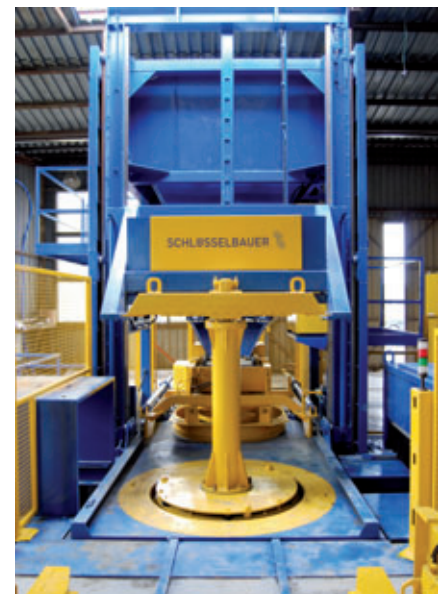
L'impianto Schlüsselbauer Magic 1501 in funzione, progettato per il comando da parte di un singolo operatore
