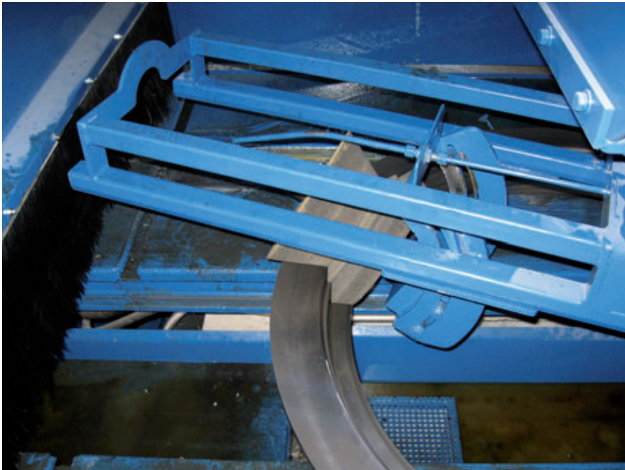
Lubrificazione tramite spugna: nessuno spruzzo, nessuna sporcizia all'interno dell'area di lavorazione
