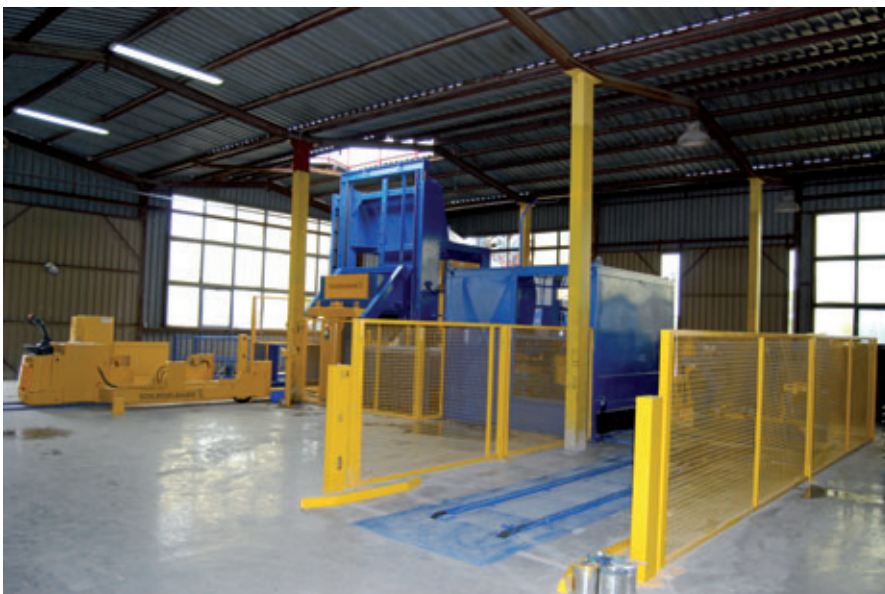
Quadro generale del nuovo impianto di produzione per la fabbricazione di anelli e coni per pozzetti e spezzoni della parte inferiore di pozzetti della ditta ABM Solid
