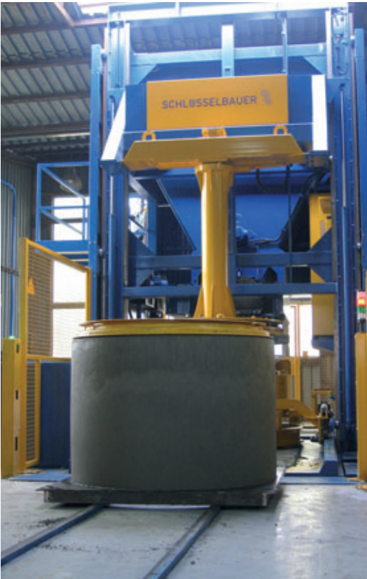
Anelli per pozzetti delle dimensioni 1000 e 1200 mm vengono prodotti con altezze pari a 500, 750 e 1000 mm
