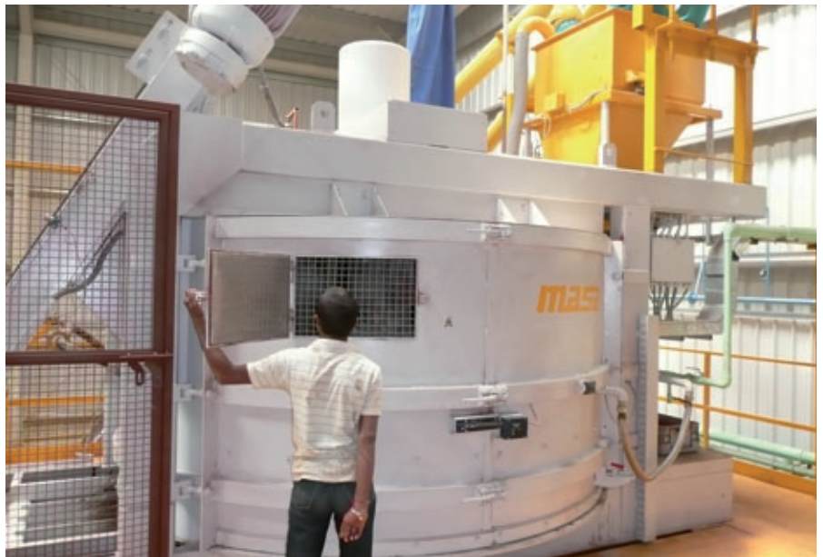
Due autobetoniere Masa producono il calcestruzzo per lo strato interno e il calcestruzzo di rivestimento per la produzione di blocchi
