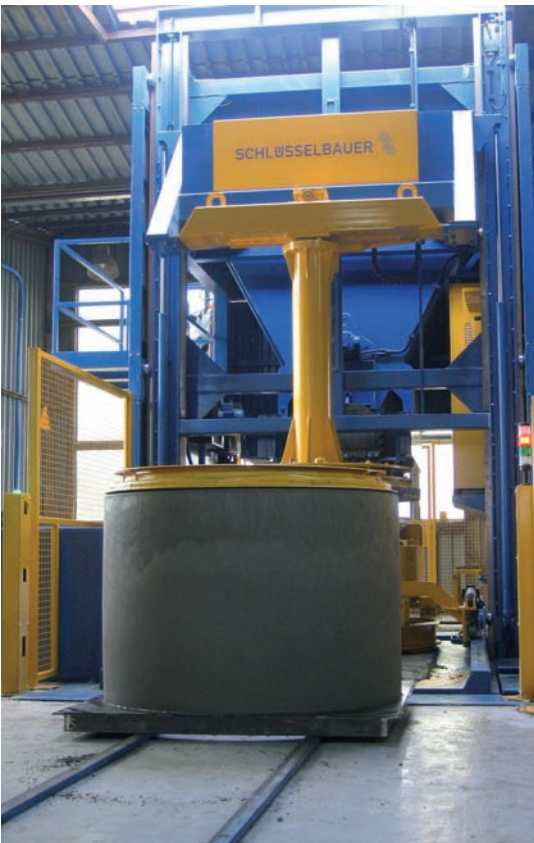
Les anneaux de regard en dimensions 1.000 et 1.200 mm sont produits en 500, 750 et 1.000 mm de hauteur.
