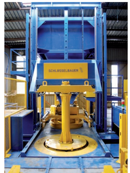
La Magic 1501 de Schlüsselbauer est conçue pour fonctionner avec un seul opérateur.
