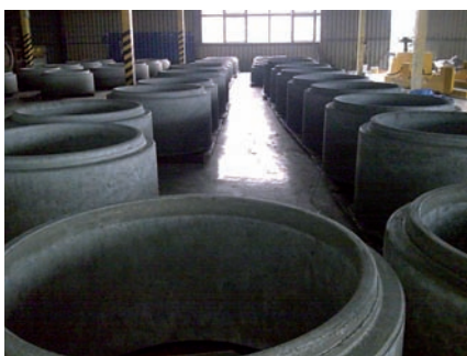
Cônes et anneaux de regard dans la zone de durcissement.
