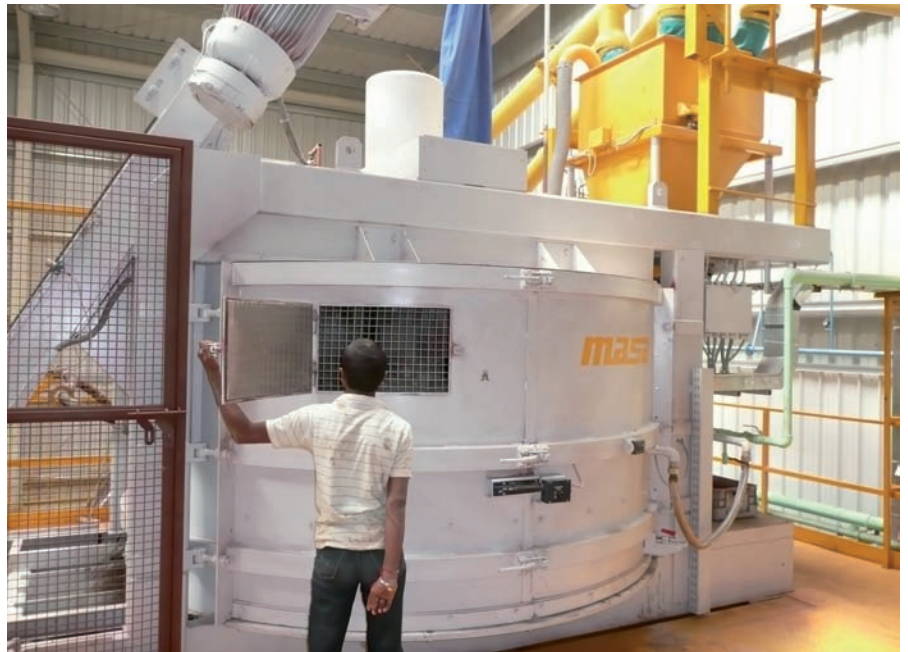
Deux mélangeurs à béton de Masa produisent le béton de parement et de remplissage pour la fabrication des blocs.
