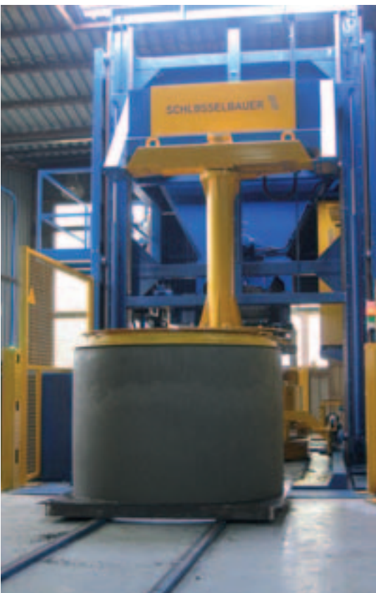
Schachtringe der Dimensionen 1.000 und 1.200 mm werden in den Bauhöhen 500, 750 und 1000 mm gefertigt.
