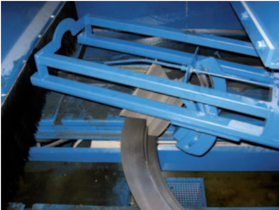
Ölung mittels Schwamm: Kein Sprühnebel, keine Verschmutzung des Arbeitsumfeldes
