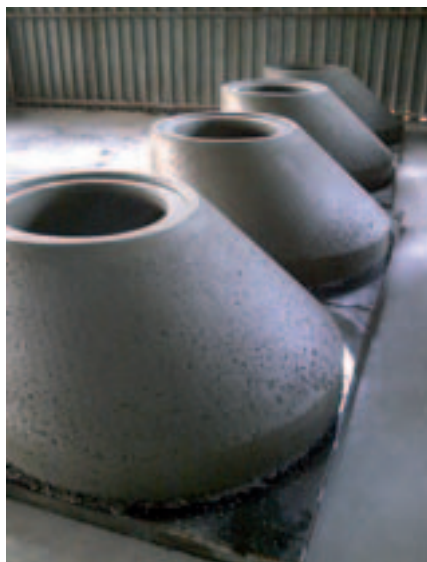
Schachtringe der Dimensionen 1.000 und 1.200 mm werden in den Bauhöhen 500, 750 und 1000 mm gefertigt.
