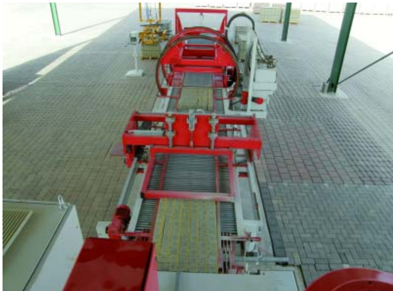
За загрузку изделий в барабан отвечают цепной транспортер и толкатель
