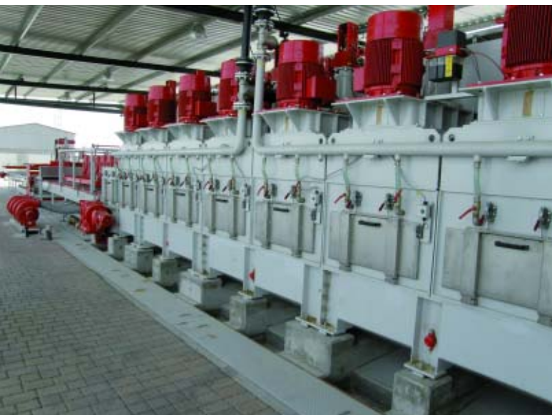
В шлифовальной машине имеются 8 станций для фрезеровки, шлифовки и полирования
