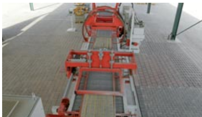
Za pomocą przenośnika rolkowego i spychacza warstw produkty są wsuwane do maszyny kalibrującej.
