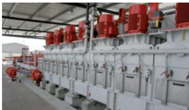
Maszyna szlifująca posiada 8 stanowisk do frezowania, wygładzania i szlifowania.
