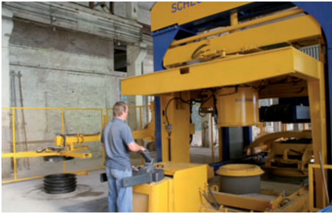
Estrazione di un anello di supporto da un impianto Magic nella centrale di betonaggio di Marijampolės Gelzbetonis.
