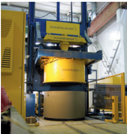
Produzione di anelli di diversi diametri nominali nelle centrali di Kauno Gelzbetonis e Vilniaus Gelzbetonis Konstrukcijs Gamykla Nr.3.
