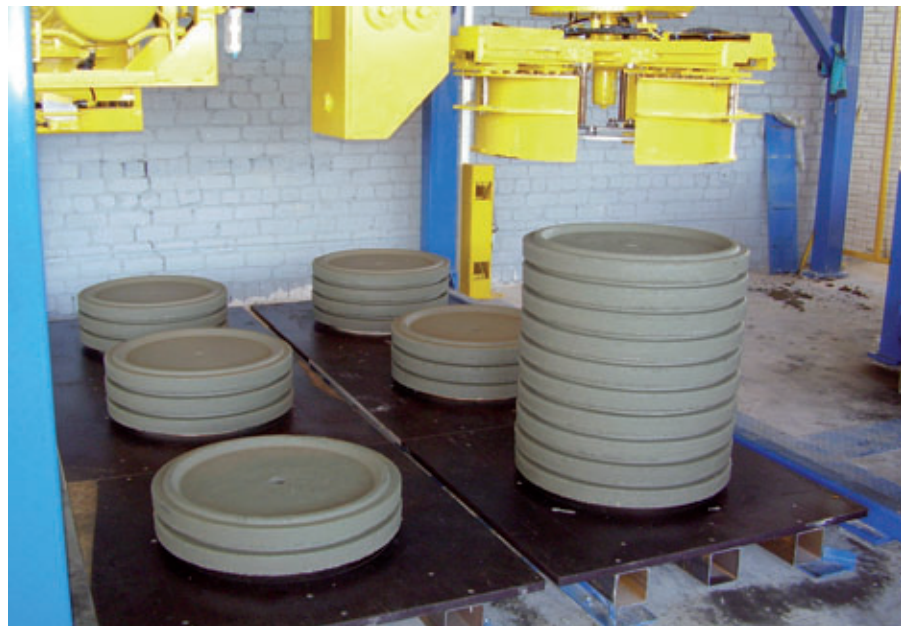
produzione di un tombino e handling tramite l'impilatore automatico Ringmaster.
