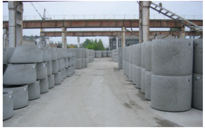
Pezzi attuali per la costruzione di pozzetti da utilizzarsi nella costruzione di canalizzazioni in Lituania (nella foto: coni e anelli a Kauno Gelzbetonis).
