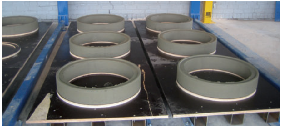
Anelli scanalati DN700 dalla produzione Ringmaster della fabbrica JSC di Gelgaudiskio Gelzbetonis
