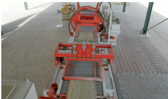
In seguito trasportatore con catena a rulli e spintore provvedono a introdurre i prodotti nella calibratrice.
