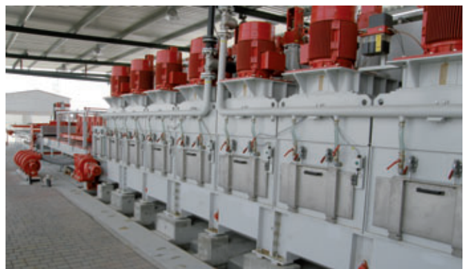
La levigatrice è dotata di 8 stazioni per fresatura, lisciatura e levigatura.
