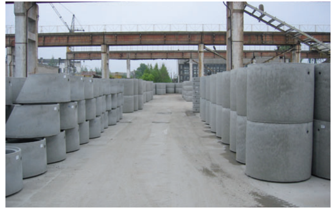
Des produits d'assainissement parfaitement contemporains en Lituanie – ici des têtes et des éléments droits chez Kauno Gelzbetonis.
