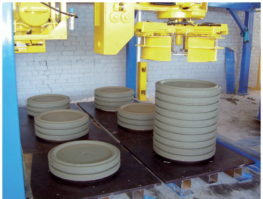
Fabrication et manutention de tampons avec le Ringmaster et son robot.
