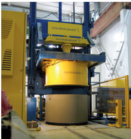
Fabrication et manutention de tampons avec le Ringmaster et son robot.
