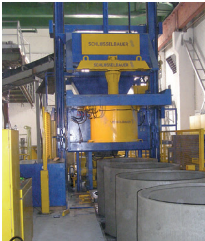
Rehausses de 700 à emboîtement mi-épaisseur provenant du Ringmaster de l'entreprise JSC Gelgaudiskio Gelzbetonis
