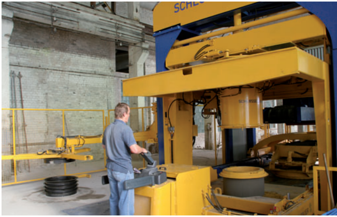
Sortie d'un élément de regard de l'installation Magic à l'usine Marijampolės Gelzbetonis.
