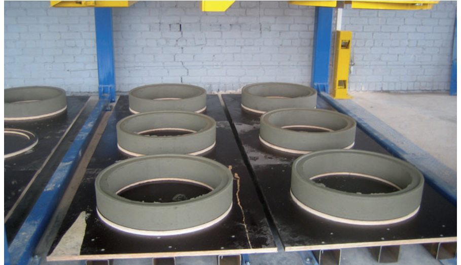
Rehausses de 700 à emboîtement mi-épaisseur provenant du Ringmaster de l'entreprise JSC Gelgaudiskio Gelzbetonis
