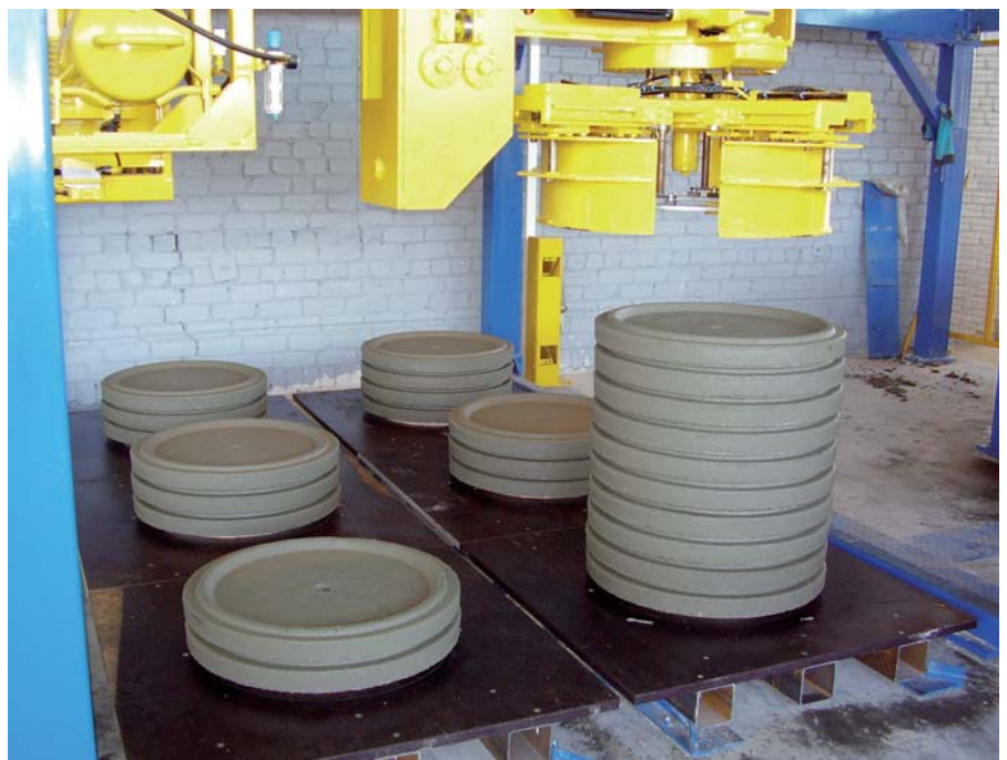
Deckel-Fertigung und Handling mittels Ringmaster-Stapel-Automaten
