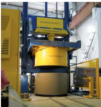
Deckel-Fertigung und Handling mittels Ringmaster-Stapel-Automaten
