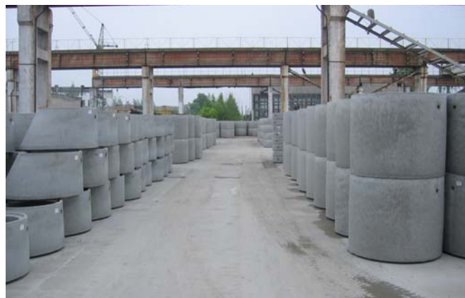
Zeitgemäße Schachtbauteile für den Tiefbau-Einsatz in Litauen – im Bild Konen und Schachtringe bei Kauno Gelzbetonis
