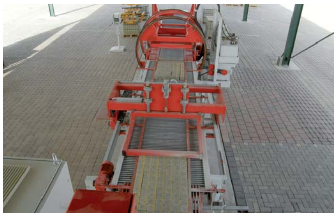
Staurollenkettenträger und Lagenschieber sorgen anschließend für das Einschleiben der Produkte in die Kalibriermaschine.
