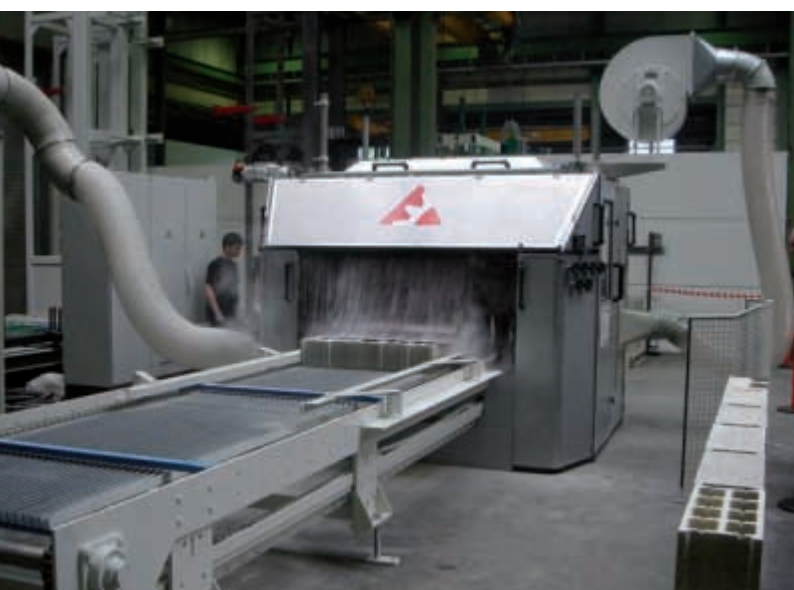
«Гвоздем» выставочной программы стала презентация новой установки Cutmaster, которая будет более подробно представлена на страницах следующего выпуска журнала «Международное бетонное производство». Cutmaster позволяет изготавливать стеновые камни с идеально ровной поверхностью для укладки при помощи энергосберегающей технологии с заменой толстого слоя раствора на тонкий слой мастики.
