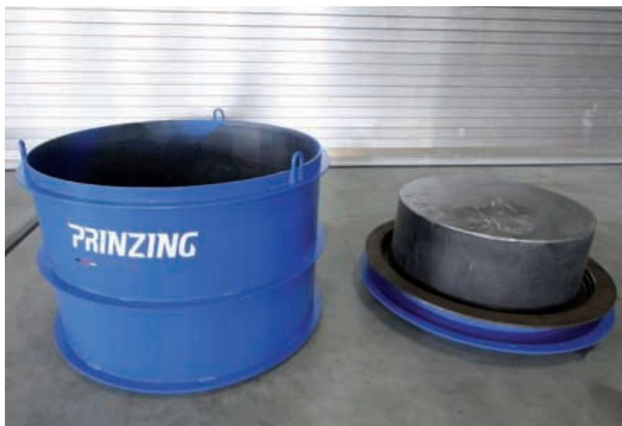
Рис. 2. Формы состоят из внутренних защитных зерен, нижних муфт и кожуха формы.
