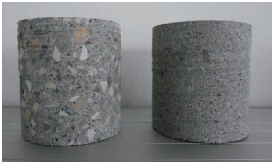
Рис. 3. Керн d = 90 мм, длина 100 мм из ствола шахты, слева – обычный бетона, справа – ствол шахты PRIMUS.
