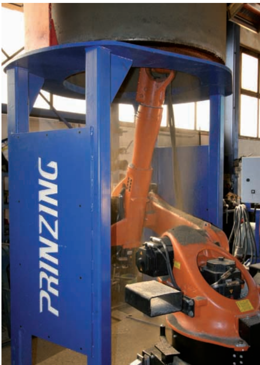
Рис. 4. Фрезерование каналов во фрезерном центре.
