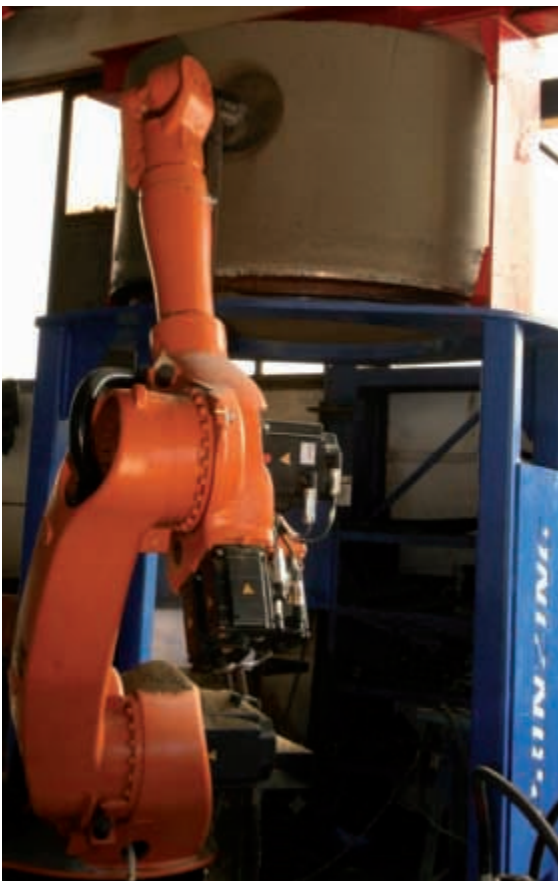
Рис. 5. Фрезерование соединений во фрезерном центре.
