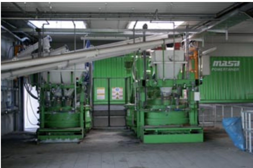
Dwie poziome mieszarki o wymuszonym obiegu mieszanki firmy Masa wytwarzają beton dla warstwy wierzchniej wyrobów i beton konstrukcyjny dostarczany do wibroprasy (w tle kontener Powertainer firmy Masa).
