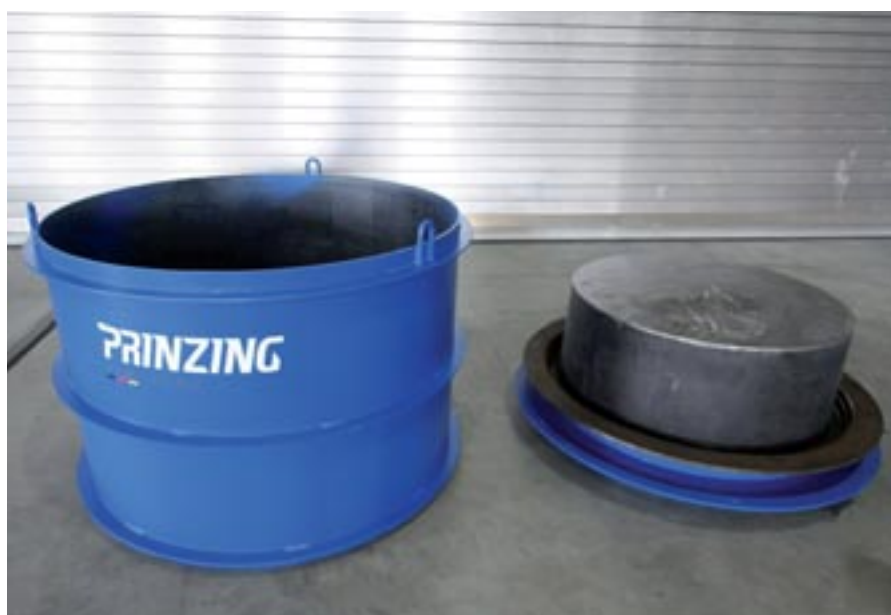
2: Formy składają się z rdzenia podporowego, mufy dolnej i płaszczka.
