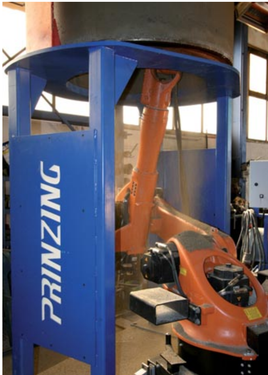
4: Frezowanie koryta na stanowisku frezowania.
