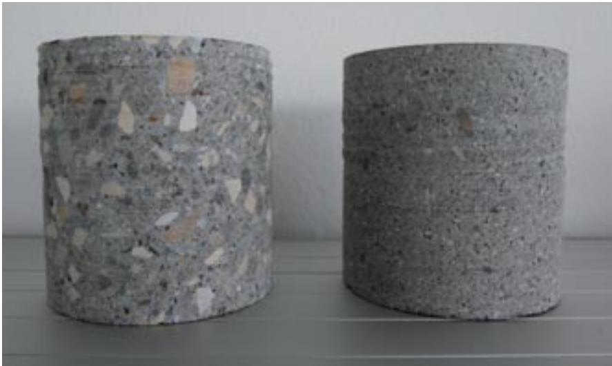
3: Próbkę cylindryczną o \varnothing 90 mm i długości 100 mm wywierconą z podstaw studzienek; z lewej beton tradycyjny, z prawej podstawa studzienki PRIMUS.
