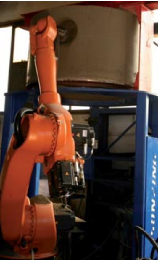
5: Frezowanie przyłączy na stanowisku frezowania.
