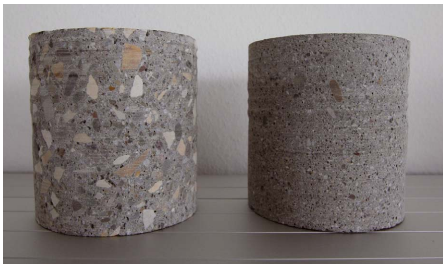
Fig. 3: Carote \varnothing 90 mm, lunghezza 100 mm dai fondi dei pozzetti, a sinistra calcestruzzo normale, a destra fondo di pozzetto PRIMUS
