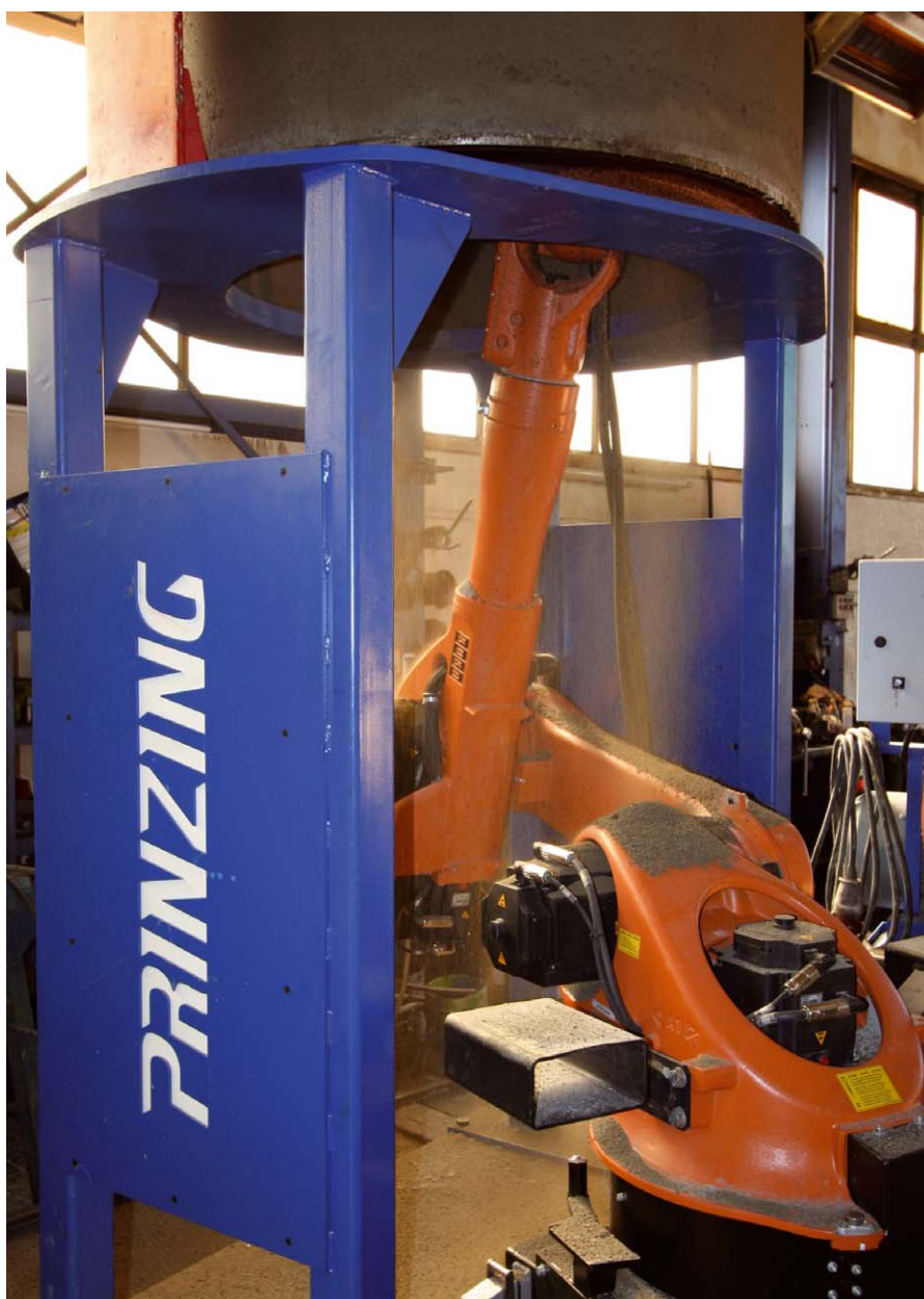
Fig. 4: Fresatura dei canaletti sul centro di fresatura
