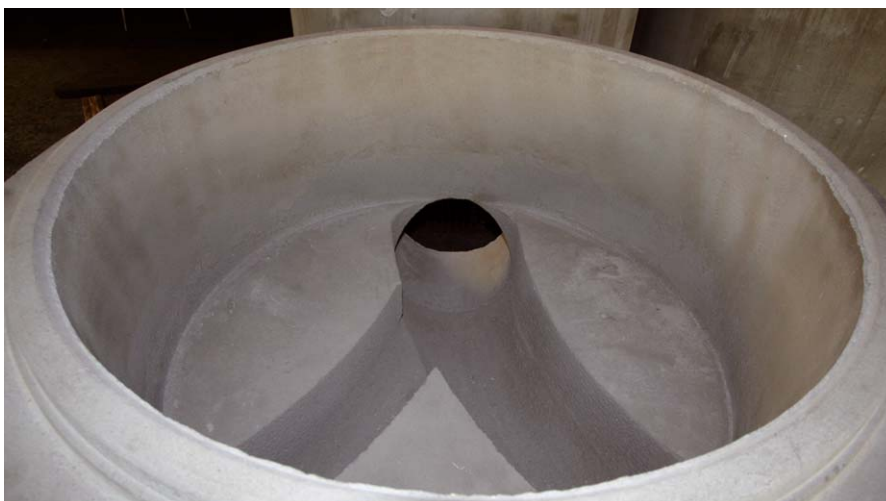
Fig. 6: Fondo per pozzetto PRIMUS con diametro nominale 1000 mm, condotti di afflusso diametro nominale 150 e 200 mm, scarico diametro nominale 300 mm
