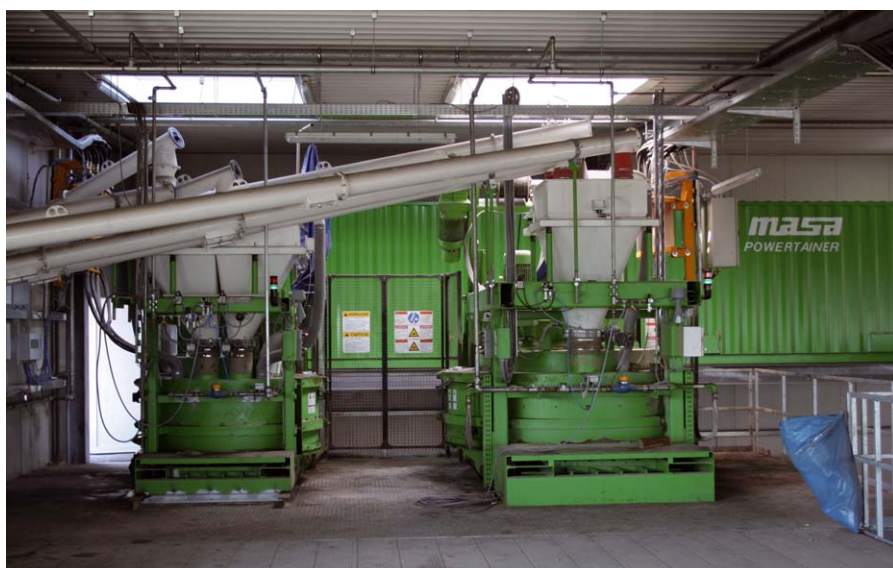
Due miscelatori orizzontali a regime forzato di Masa producono calcestruzzo per lo strato di rivestimento e per lo strato interno per la produzione di blocchi (nella foto con un Masa Powertainer).
