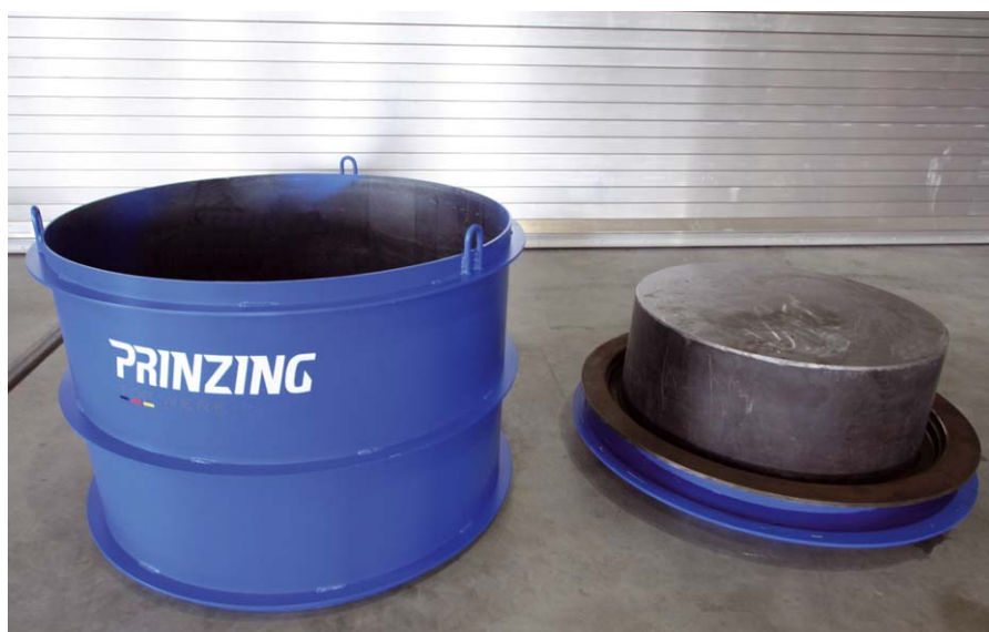
Figure 2: Les formes se composent de noyaux support internes, de rondelles de base et de moules extérieurs
