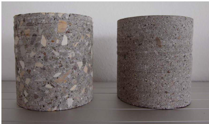
Abb. 3: Bohrkern \varnothing 90 mm, Länge 100 mm aus den Schachtunterteilen, links Normalbeton, rechts PRIMUS-Schachtunterteil
