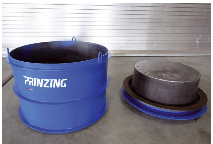
Abb. 2: Die Formen bestehen aus Innenstützkern, Untermuffen und Formmantel.
